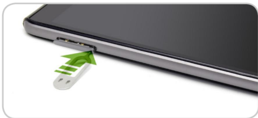
Mit einem SIM-Auswurf-Tool oder einer Büroklammer drücken Sie sie nach innen. Das Sim-Karten Fach ist jetzt geöffnet.
